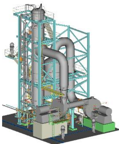
図1. MVR型蒸発濃縮装置 (3Dイメージ)
